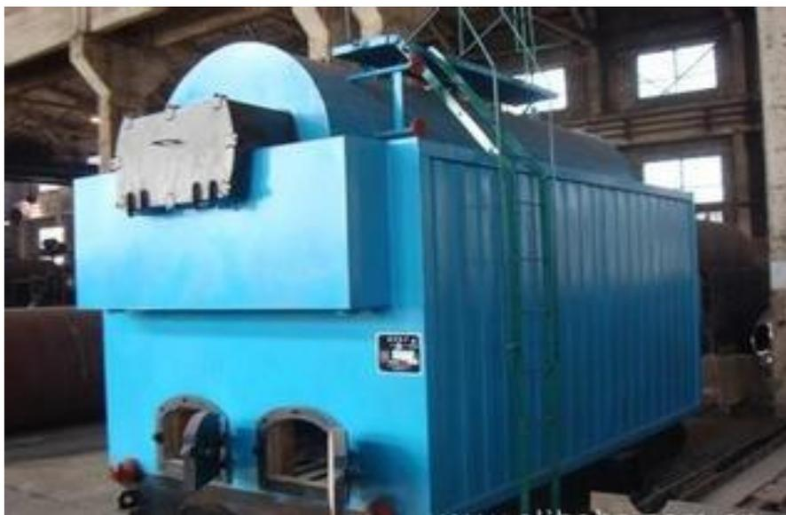
图 2：蒸汽锅炉
